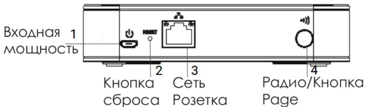
Рисунок 1 – схема подключения Базы
